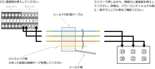
他の電圧線と接触しないよう絶縁処理を施してください。 外部信号端子(CN1)下部のケーブルハリルタにねじ止め、またはFG クランプにて取り付けてください。
