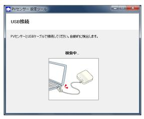
2. USB ケーブルを、パソコンの USB コネクタ(A)と本体ユニットの USB コネクタ(ミニ B)に接続します。
