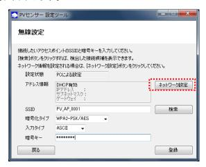
(2) ネットワーク設定画面が表示されます。センサーが使用するネットワーク情報を選択・入力します。
