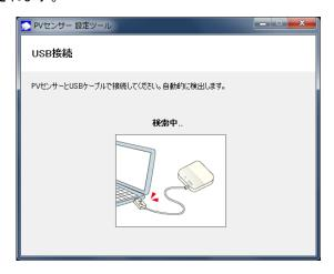
3. USB ケーブルを、パソコンの USB コネクタ(A)と本体ユニットの USB コネクタ(ミニ B)に接続します。
