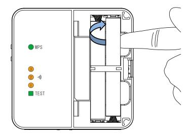
5. 電池を取り出して 15 秒以上経過してから、単3形電池4本をセットします。電池スペースの底の表示と、電池のプラス極とマイナス極の向きを合わせてください。左側の電池2本は下から上に挿入し、右側の電池2本は上から下に挿入します。
