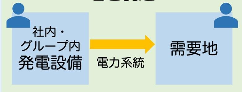
自己託送とは、遠隔地にある“自家用発電設備”で発電した電力を、別の場所にある工場などへ供給するために、電力系統を介して送電する一般送配電事業者が提供する送電サービスのことです。
