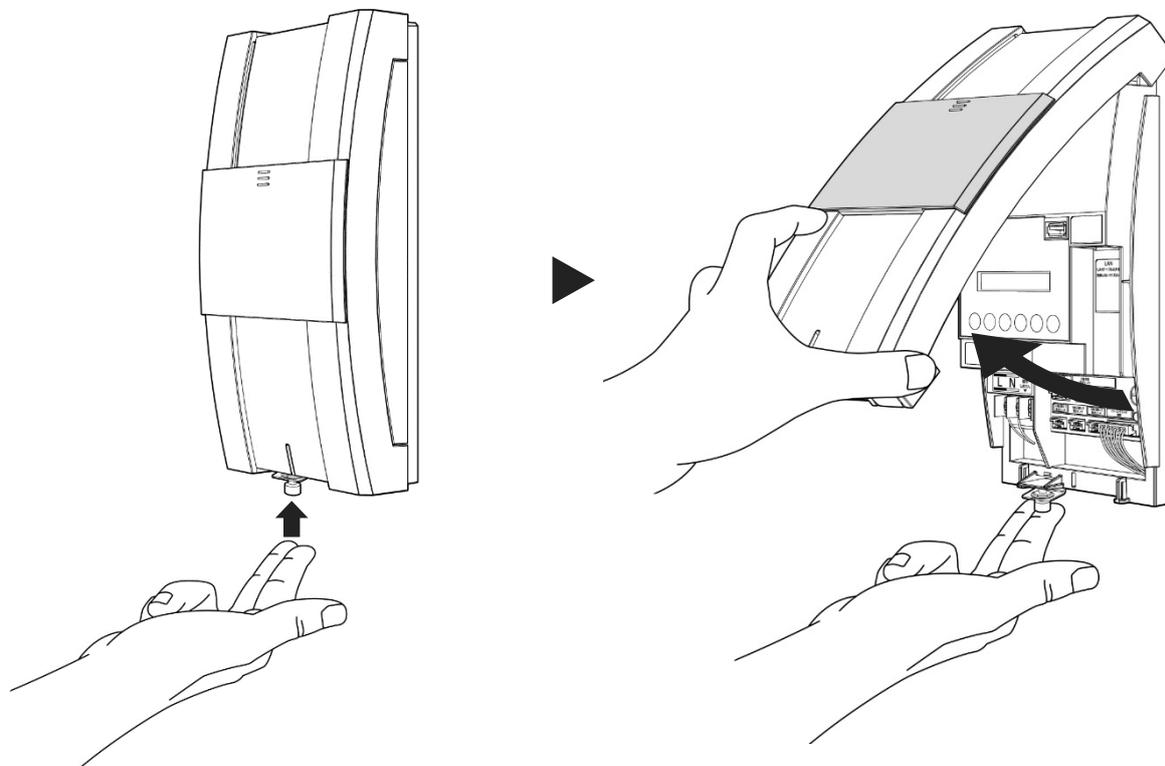
2 計測ユニットにパワコン・計測ユニット間通信ケーブルをつなぐ。
