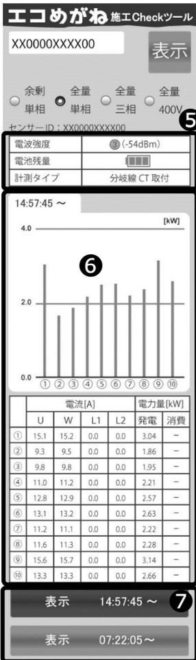
⑤ PV センサーの電波強度、電池残量、計測タイプが表示されます。AC アダプタタイプの場合は、電池残量は常に満充電の表示になります。
