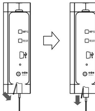
② CTコネクタ [B] のツメを、本体ユニットの前面側に押しながら CT ケーブルを引き抜きます。
