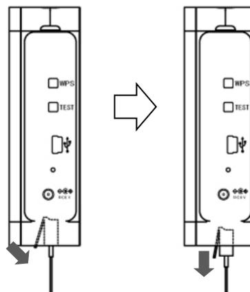
② CT コネクタ [B] のツメを、本体ユニットの前面側に押しながらか CT ケーブルを引き抜きます。
