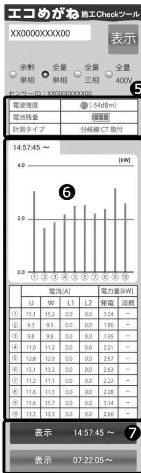
5 PV センサーの電波強度、電池残量、計測タイプが表示されます。AC アダプタタイプの場合は、電池残量は常に満充電の表示になります。
