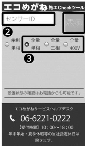
2 PV センサーに記載されている 12 桁のセンサー ID を入力してください。
