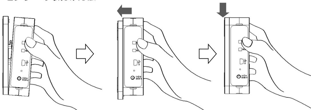
① 本体ユニットの背面の取り付け穴を壁掛けプレートのフックに掛け、壁側に軽く押し当てながら下げてください。取付けられましたら、CT ケーブルのコネクタ、及び AC アダプタを取り付けてください。
