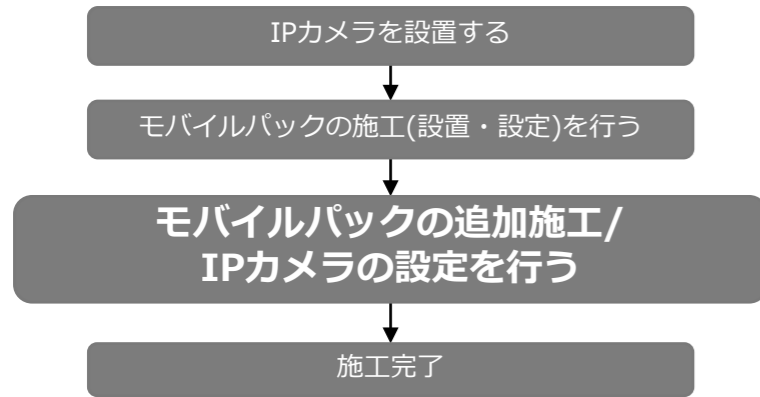
図1 システム全体での施工の流れ
