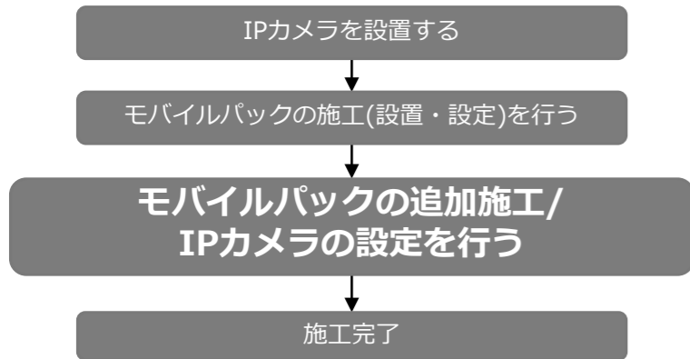
図1 システム全体での施工の流れ
