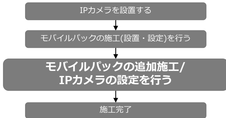
図1 システム全体での施工の流れ
