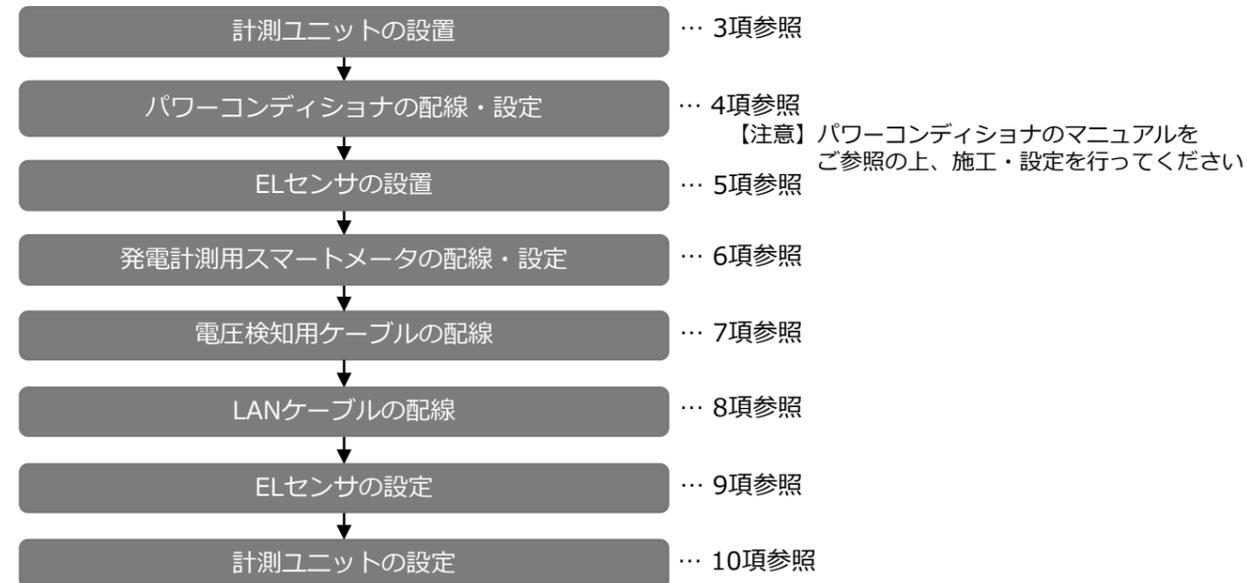
図1. エコめがね自家消費RS 施工の流れ
