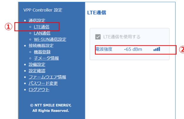
図11. LTE電波強度の確認
