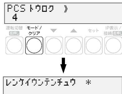
P.64に記載の出力制御設定を行ったあとに、パワーコンディショナの追加を行った場合は、追加したパワーコンディショナの出力制御設定が必要です。再度出力制御設定を行ってください。
