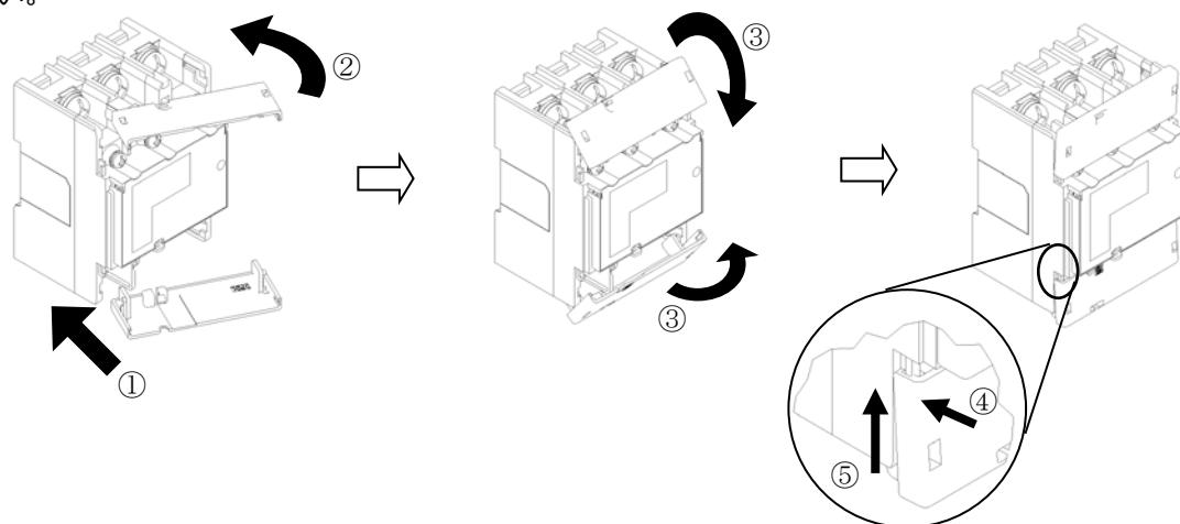
①端子カバーの片側凸部をカバーの溝に入れます。
