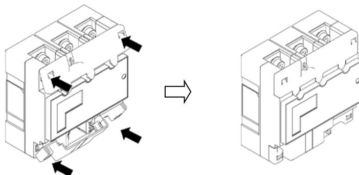
ひっかけ部をはめ込み、押し込むことで端子カバーが固定されます。
