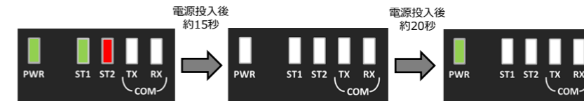
図7. SVセンサの起動時のLEDランプ状態
