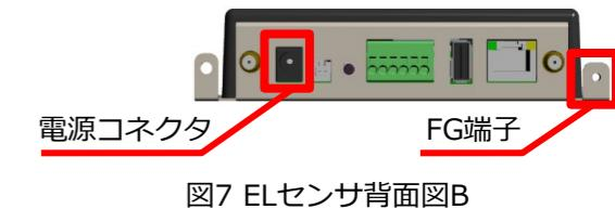
図7 ELセンサ背面図B
