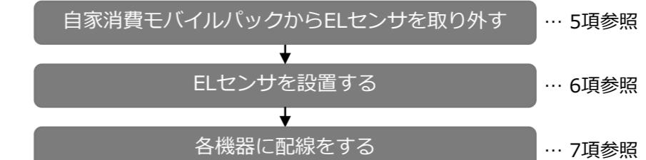
図2 自家消費モバイルパック追加施工の流れ
