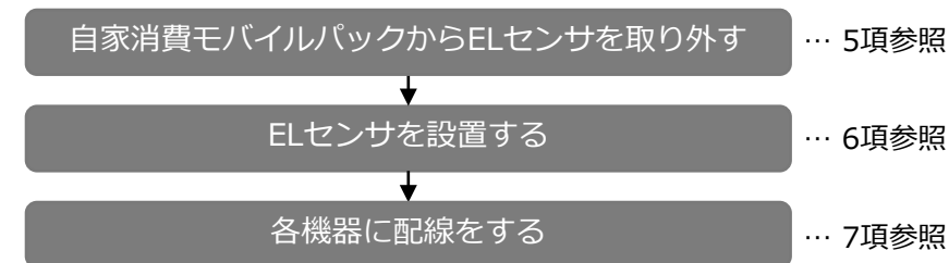
図2 自家消費モバイルパック追加施工の流れ
