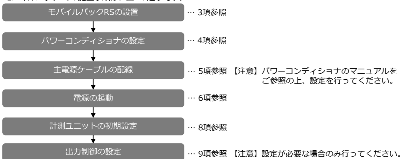
図1. モバイルパックRS施工の流れ
