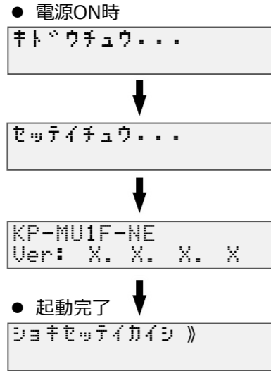
図6. 計測ユニット起動時の表示部状態
