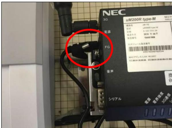
4) 3G ルータを固定しているナベネジ (2箇所) を取り外し、3G ルータ本体を架台から取り外します。
