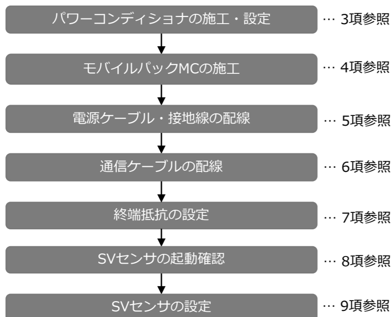
図1. モバイルパックMC施工の流れ
