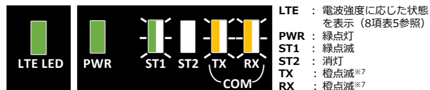
図13. SVセンサ設定完了後の表示LEDランプ状態
