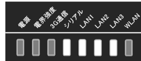
図1 3Gルーター起動時のLEDランプ状態 (正常時)
