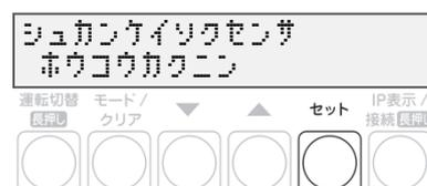
4 「デンリョク(ハツデン)OK」と表示され、パワーコンディショナ/外部発電機の発電電力\*が「0W」になっていることを確認し、▼ / ▲ボタンを押す
