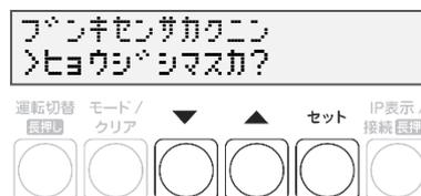
5 ▼ / ▲ボタンで各分岐計測用電流センサの設定を確認し、セットボタンを押す
