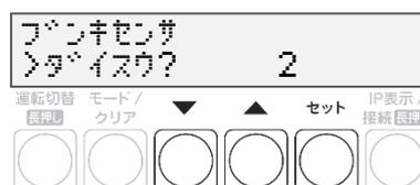
2 ▼ / ▲ボタンで分岐センサ01を設置した分岐ブレーカの電圧(100Vまたは200V)を選び、セットボタンを押す
