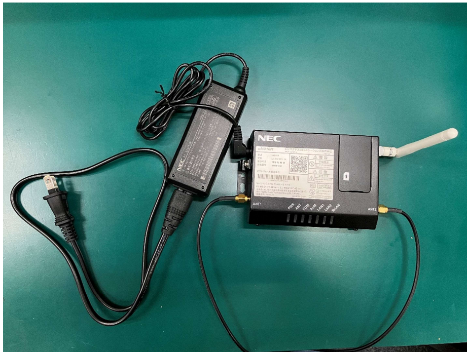
LTE ルータの配線接続状態
