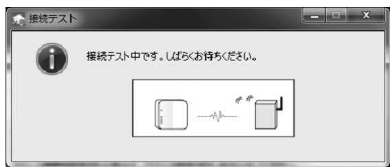
9. 登録後USBケーブルを外し、PVセンサーのTESTボタンを押して、動作確認を行います。
