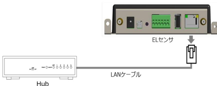
(3) (2) で外した LAN ケーブルを、交換後の EL センサに接続する
