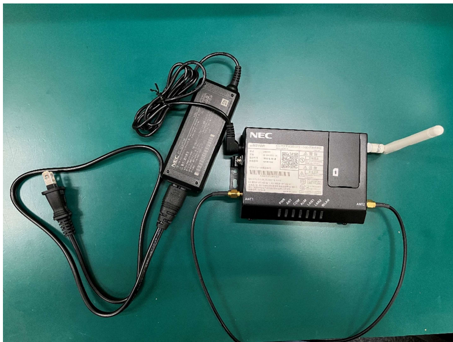
LTE ルータの配線接続状態
