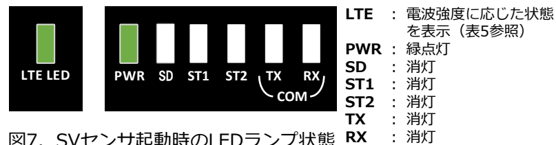
図7. SVセンサ起動時のLEDランプ状態
